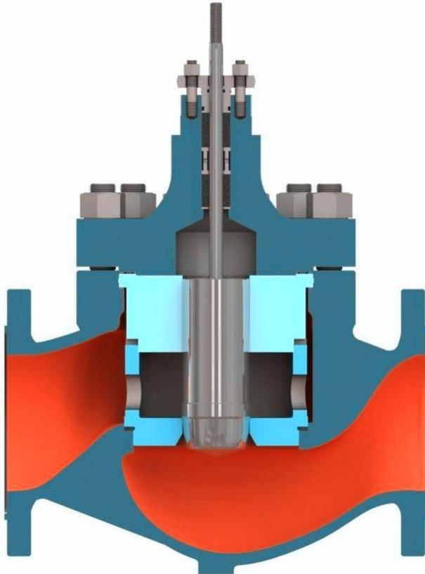
◆笼式单座调节阀阀体结构紧凑，流体通道呈S型，具有压降损失小，流量大，可调范围广。阀芯部分导向面积大，抗振性能强。泄漏量符合ANSI B16.104标准。该阀配用气动薄膜执行机构、气动活塞式执行机构或电动执行机构，其结构紧凑，输出力大。笼式单座调节阀适用于高压差易产生闪蒸的场合，是一种高性能调节阀，坚固的套筒保护阀体不受闪蒸和空化的破坏。
